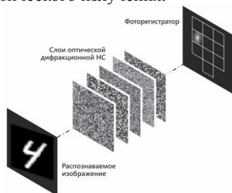
Рис. 1. Принципиальная схема оптической дифракционной нейронной сети
