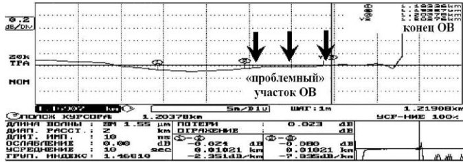
Рис. 1. Рефлектограмма OTDR для «проблемного» участка
