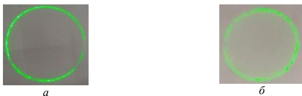
Рис. 2. Распределение интенсивности поля излучения с наибольшей каустикой \bar{\chi} \approx 0,95 в КП-ОВ/600 \mu\text{m} (а) и \bar{\chi} \approx 0,93 в КП-ОВ/200 \mu\text{m} (б), объектив 10\times , 0,4, \lambda = 532 \text{ nm} .
