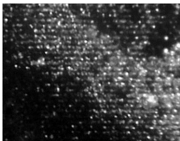
Рис. 1. Фрагмент микрофотографии поверхности X -грани образца \text{LiNbO}_3:\text{Cu} с агрегированными наночастицами \text{Al}_2\text{O}_3
