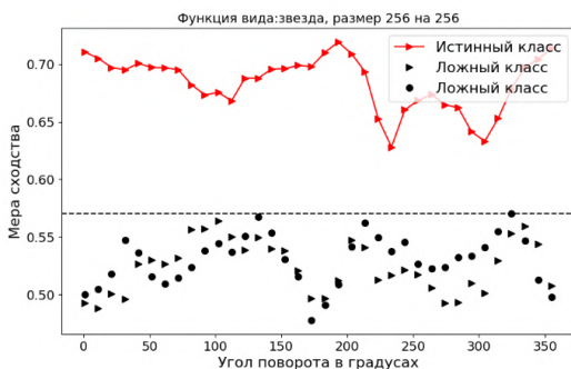
Рис. 3. Зависимость меры сходства полученной взаимокорреляционной функции и использованной при синтезе сглаживающей функции от угла поворота объекта на входном изображении
